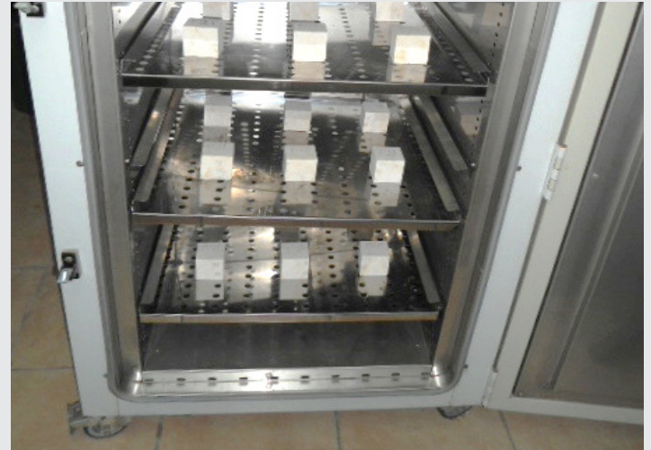
Figura 8. Fotografía de las probetas dentro de horno
